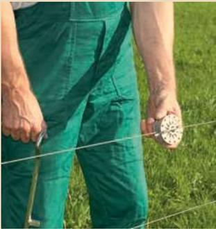
1. Spanner in den Draht einlegen, Spannbügel einsetzen
