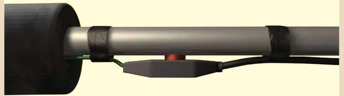
Thermostat mit Fühlerkontakt fest an die Rohrleitung anlegen und mit Isolierband umwickeln; die Platzierung des Thermostates sollte unbedingt an der kältesten Stelle der Wasserleitung erfolgen.
