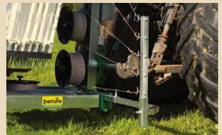
Beidseitiges Arbeiten durch umsteckbaren Auslegearm
