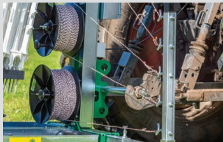
Bis zu 5 Lizen können gleichzeitig gezogen oder aufgerollt werden
