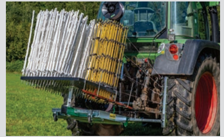
Wechselbares Magazin für bis zu 400 Pfähle
