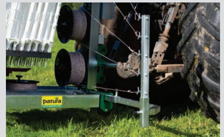
Beidseitiges Arbeiten durch umsteckbaren Auslegearm
