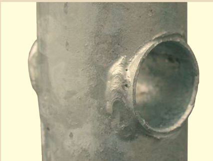
Hülse für stabile Aufhängung der Augenschrauben
