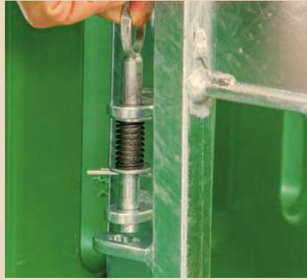
Federriegel an der Zugangstür
