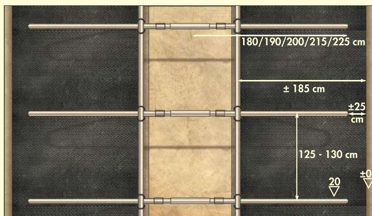
Variante 3: Montagemaße Liegeboxenbügel Universal Doppelreihe auf Montagebock für Großvieh, Beispiel Hochbox
