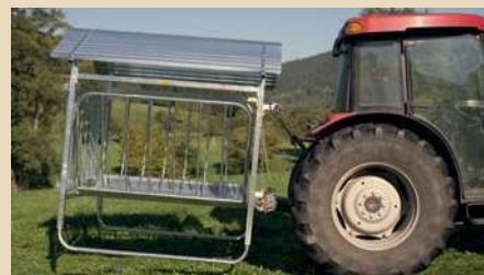
Dreipunkthanhängung für sicheren Transport
