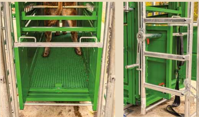
8 Klapptüren in Heckschiebetür für Klauenpflege
