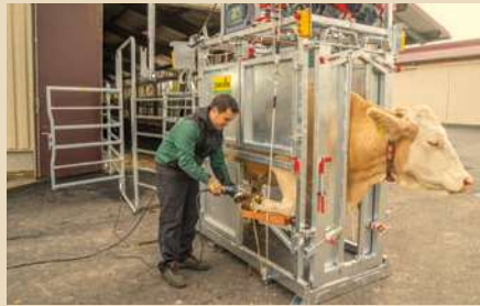
Komfortable Klauenpflege dank Elektrowinden
