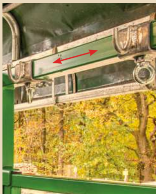
9 Haken für Bauchgurt beliebig verstellbar
