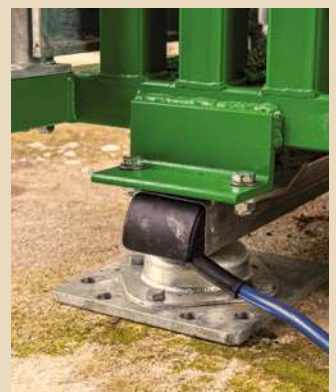
10 Integrierte Montageplatten für Wiegebalken HD5T
