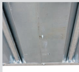
Doppelte Verstärkungsrohre unter dem Bodenblech
