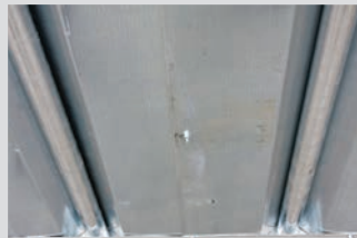
Doppelte Verstärkungsrohre unter dem Bodenblech
