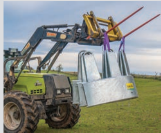
Aussparungen zum hängenden Transport
