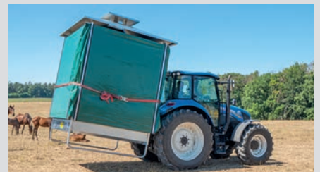
Transport über Dreipunkthanähung, ungefüllt mit max. 10 km/h, mit eingeklappten Dachsegmenten
