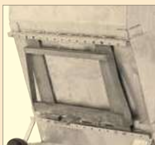
5. Weidemann mechanische Verriegelung, obere Einhängehöhe: 927 mm
