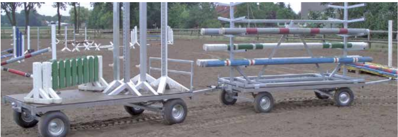
Wagen links: mit Breitbereifung, Kugelkopplung und Kugelumkopplung, Wagen rechts: mit Kugelkopplung und Transportgestell in Sonderbauweise
