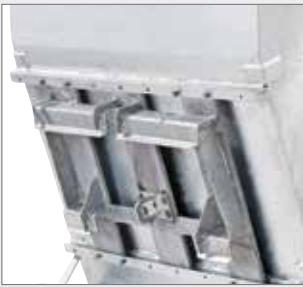
5. Schäffer-Hoflader mechanische Verriegelung Obere Einhängehöhe: 966 mm
