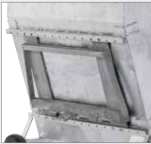
2. Weidemann mechanische Verriegelung Obere Einhängehöhe: 927 mm
