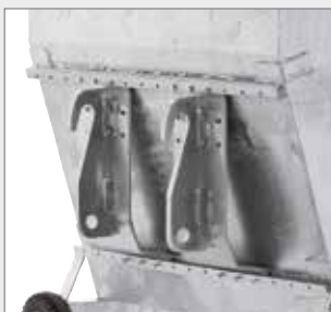
3. Weidemann hydraulische Verriegelung Obere Einhängehöhe: 915 mm
