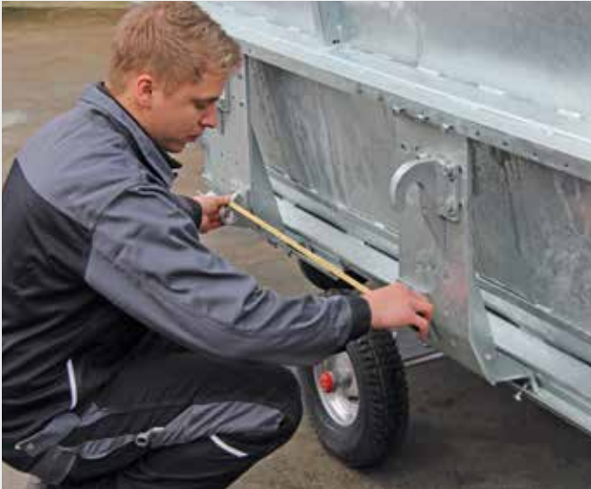
Einmalige Ersteinstellung der Aufnahme für den Frontlader. Danach ist der Großraumkuli sofort einsatzbereit.
