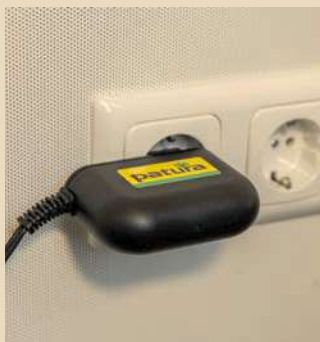
230 Volt Wechselstrom aus der Steckdose
