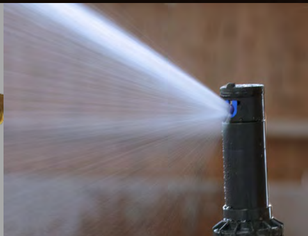
Regnerkopf am Pfosten installiert
