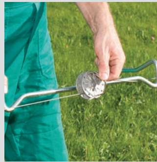
3. Spannugel in den Draht einhangen, Sicherungsugel einsetzen und Spannugel entnehmen
