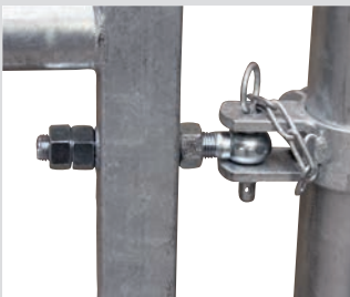
Verstellbare Aufhängung unten mit Augenschraube M22 zum Ausgleich von schrägen Montagepfosten
