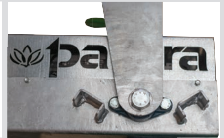
Massive Begrenzungsanschlüsse für eine gute Führung des Bürstenkörpers
