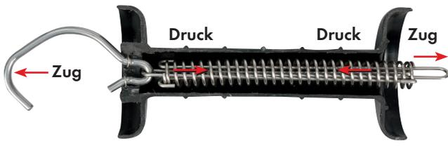
Schnitt durch den Spezial-Torgriff mit Zugbegrenzung: Die Zugkraft auf den Torgriff wird in eine Druckbelastung auf die Feder umgewandelt, d.h. die Feder wird zusammengedrückt und eine Überdehnung der Feder wird verhindert.
